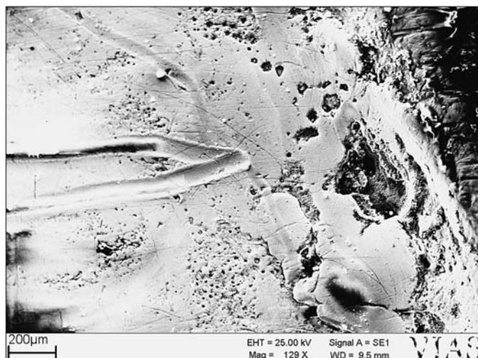
**Abb. 2** Knauf, Kat.-Nr. 23, Schale 1. Detailaufnahme, in den Vertiefungen der Beschläge ist eine Feuervergoldung zu erkennen.
